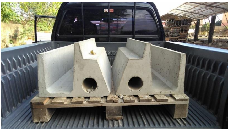
Figura 3: elemento de fundação em argamassa armada associado a canaleta de águas pluviais. Peso = 80kg. Passível em transportar manualmente por duas pessoas. Fonte: peça e imagem realizada pelo autor.
