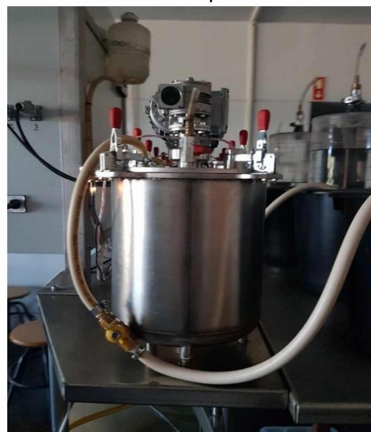
Figura 2 - Reator de 5 litros do biodigestor utilizado para o estudo
