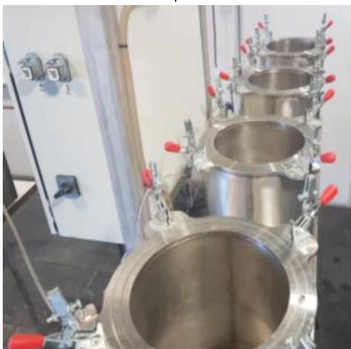
Figura 1 - Biodigestor utilizado no estudo com quatro reatores
