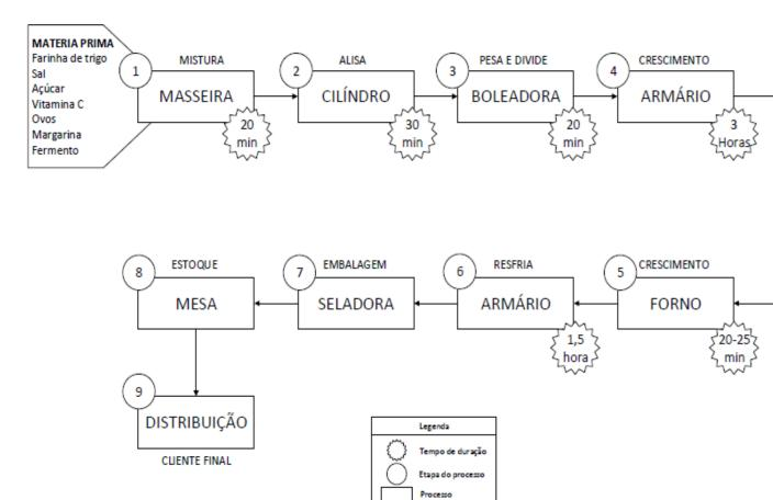
Desenvolveu-se a planta baixa da fábrica. Na figura abaixo, é numerada uma sequência, de 1 a 8, que corresponde ao uso de máquinas e equipamentos para a produção do pão de hambúrguer, produto principal da fábrica.
